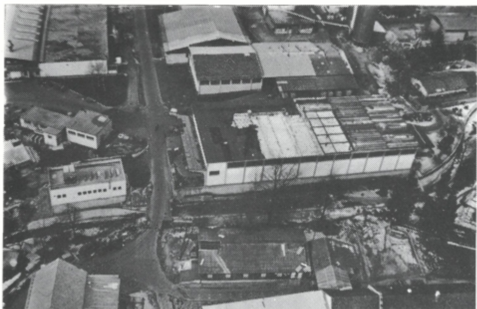
Sl. 13. Veliko škodo je naredil ta vihar tudi na strehah tovarne Elan v Begunjah, ki so prečno na smer vetra.
