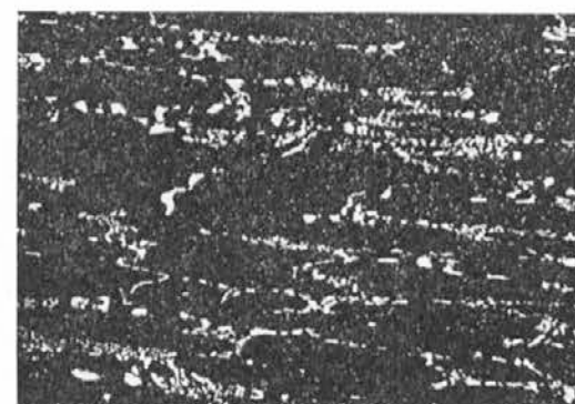
Slika 3.2 — struktura brzoreznega jekla, proizvedenega na klasičen način vzdolžne predelave
