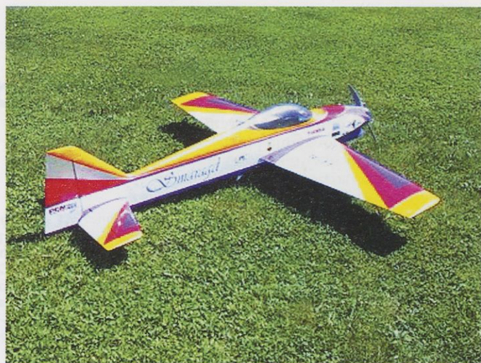
Sodobni širokotrupi akrobatski model F3A 2 x 2 m Rolanda Matta (proizvajalec PLPROD). Opremljen je s štiritaktnim motorjem s prostornino 23 cm 3 .
