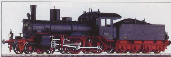
Rocov iz kovine vrhunsko izdelan in detajliran model parne lokomotive BR36 bo zanimiv za marsikaterega ljubitelja modelnih železnic. Motor je v tenderju, kjer so tudi pogonska kolesa. Pogon se prenaša tudi v sprednji del lokomotive prek kardanskega prenosa.
