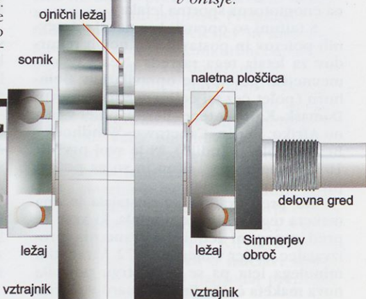
Ležaja in Simmerjeva obročka sta vtisnjena v ohišje.
