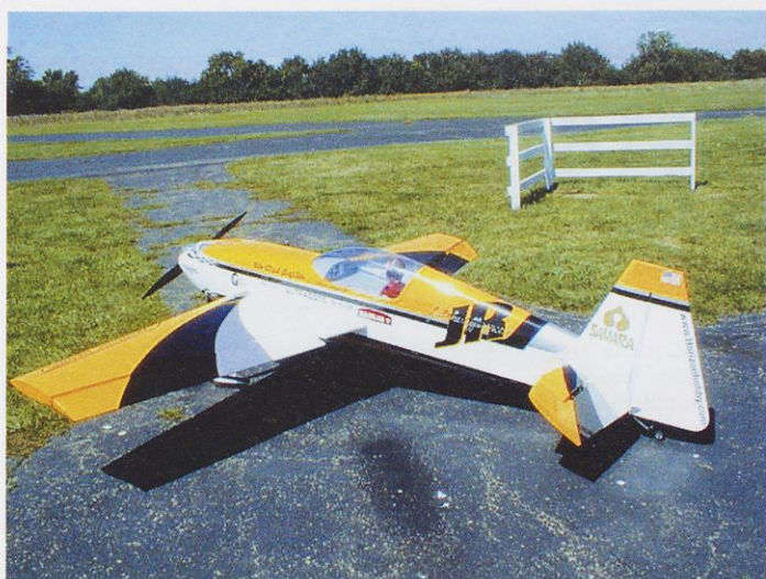
RV-pilot Mike McConville leti s 40-odstotno extro 300S klasične konstrukcije s stiropornim krilom iz sestavljanke podjetja Carden. Model žene motor s prostornino 150 cm 3 .
