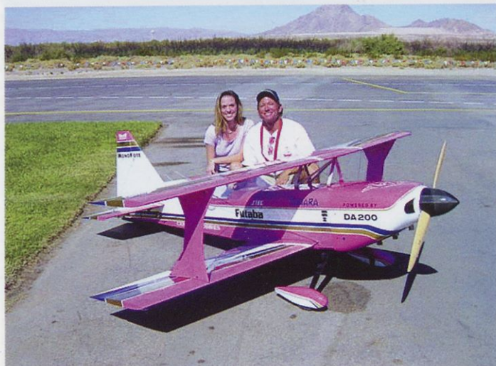
Zadnji zmagovalec tekmovanja TOC v Las Vegasu, Američan Chip Hyde, s klasično grajenim dvokrilnikom ultimate (proizvajalec Aeroworks), ki ga poganja štirivaljni motor bokser 200 cm 3
