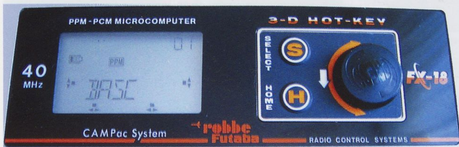
LCD-prikazovalnik bi lahko bil boljši, a je programiranje z dvema tipkama in gumbom kljub temu hitro. Sistem programiranja je povzet po starejši napravi FC-16 in večini uporabnikov ne bo povzročal preglavic.
