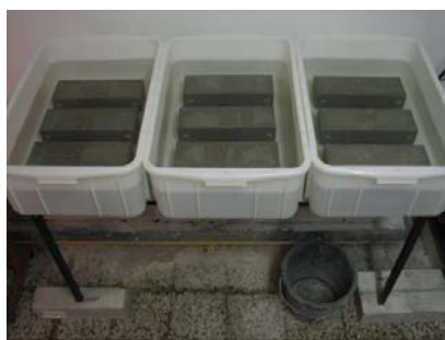
Slika 5.43: Potopitev betonskih preizkušancev v sulfatno raztopino pri (20\pm 1)^\circ\text{C} Fig. 5.43: Immersion of concrete specimens in sodium sulfate solution at (20\pm 1)^\circ\text{C}
