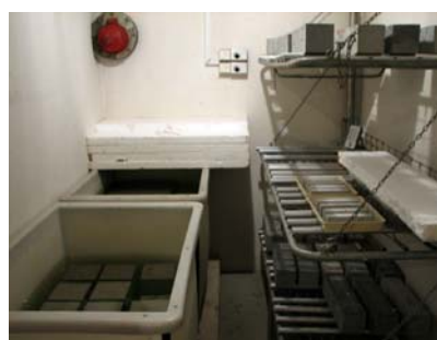
Slika 4.1: Nega betonskih preizkušancev takoj po vgrajitvi v kalupe (levo) in po razkalupiranju (desno)
