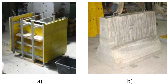
Slika 3.14: Skrajšana AB varnostna ograja »New Jersey«: a) izdelan opaž; b) končni izdelek Fig. 3.14: Shortened New Jersey concrete barrier: a) manufactured formwork; b) finished element
