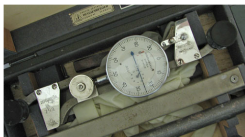
Slika 5.42: Huggenbergerjev deformeter z natančnostjo 0,0001 inče (levo) in meritve vzdolžnih deformacij betonskih prizem (desno)
