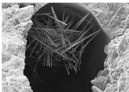
Slika 5.41: Primer neovirane tvorbe sekundarnega etringita v zračni pori (Mehta, Monteiro, 2006)
