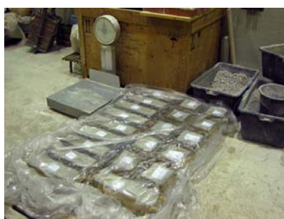
Slika 4.1: Nega betonskih preizkušancev takoj po vgrajitvi v kalupe (levo) in po razkalupiranju (desno)
