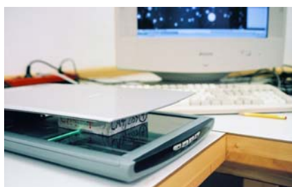
Slika 6.16: Naenkratno zajemanje celotne preiskovane površine vzorca z optičnim čitalcem z visoko resolucijo
