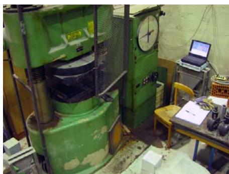
Slika 4.3: Tlačna preša z računalniškim zajemanjem podatkov
