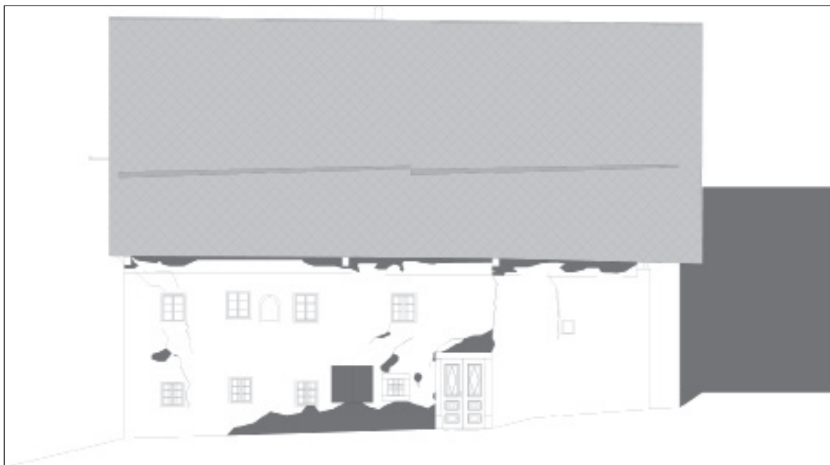
Slika 16. Prikaz vidnih poškodb na stavbnem oboju Šinkovčeve hiše. / Vir: Avguštin in drugi, 2012: Seminarska naloga pri predmetu Prenova in konservatorstvo. Fakulteta za arhitekturo, Univerza v Ljubljani, Ljubljana.
