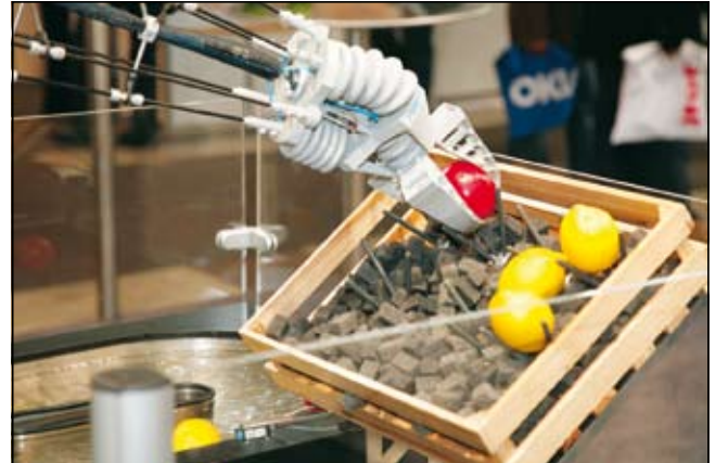
Prijemalo prime paradižnik, ne da bi poškodovalo njegovo nežno povrhnjico.
