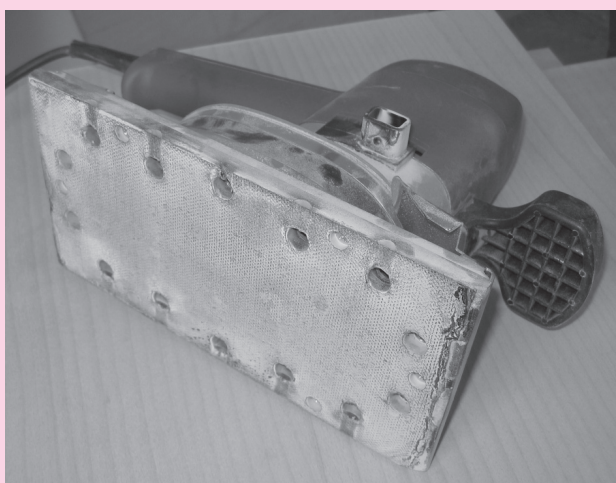
□ Brusilnik po prestanem testu – poškodovana je le obloga na osnovni plošči
