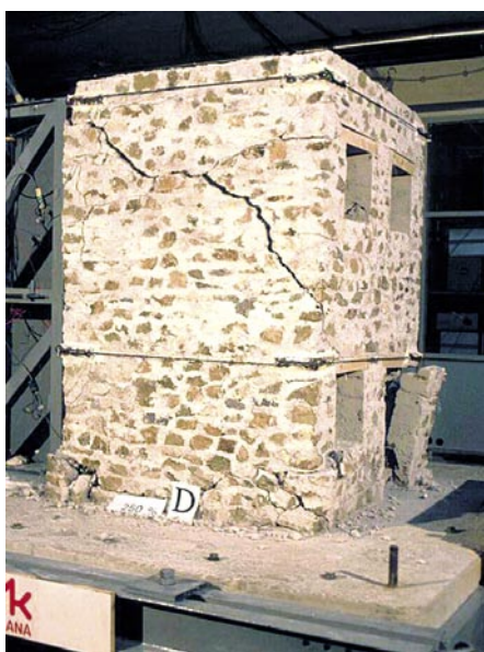
Slika 23 • Mehanizem porušitve modela kamnite hiše s povezanim zidovjem
