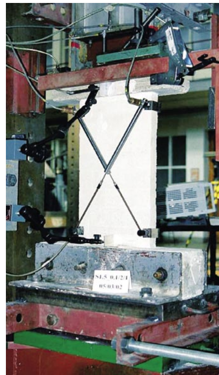
Slika 5 • Preiskava modelnega zidu v posebej zasnovani napravi
