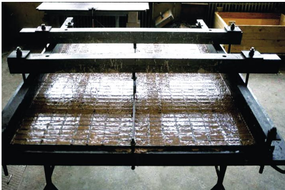
Slika 4 • Izdelava modelnih zidakov z jeklenim opažem
