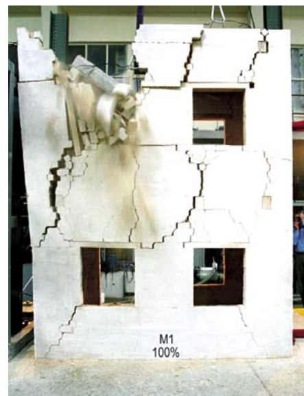
Slika 26 • Mehanizem porušitve modela kamnite hiše z nepovezanim zidovjem
