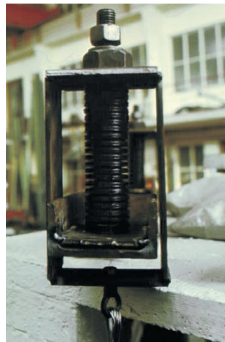
Slika 10 • Pri enostavnem modelu zahtevana napetostna razmerja ustvarimo s prednapetjem zidov. Silo vnašamo z mehki vzmetmi
