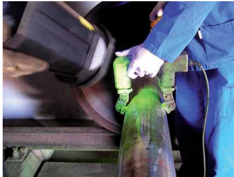
Preizkus za vzdolžne razpoke z ročnim jarmom.
