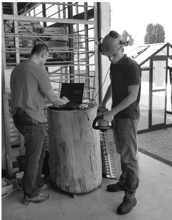
Slika 6. – Položaj rukovatelja pri mjerenju vibracija koje se prenose s uređaja na sustav šaka – ruka prema preporukama ISO 7505
