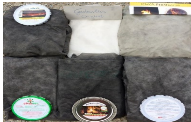
Bild 4: Aufgrund der Beobachtungen hinsichtlich der Rußentwicklung (Kontrollvlies oben mittig) kann unter Folie nur die JOKA-Frostkerze (hellgrau - rechts oben) empfohlen werden.
