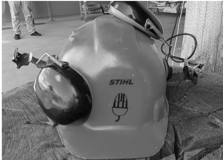
Slika 9. – Zaštitna kaciga na koju je montiran uređaj za mjerenje razine buke
