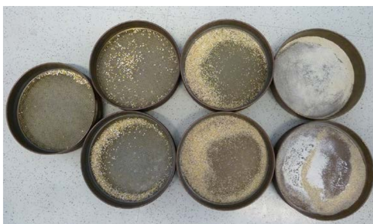
Slika 3: Ostanki krmila na posameznih sitih in skodeli klasičnega sejalnega testa Vir: foto Vida Rezar
