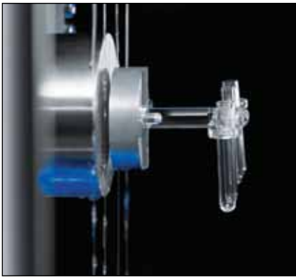
Slika 8. Primer zasnove prihodnosti (angl. future concepts) je superprevodnik, ki ohlajen na temperaturo prehoda v supraprevodnost omogoča, da magnet lebdi nad njim v stabilni legi, kar lahko uporabimo za brezstično držanje in premikanje predmetov. (foto: Festo AG &Co. KG).
