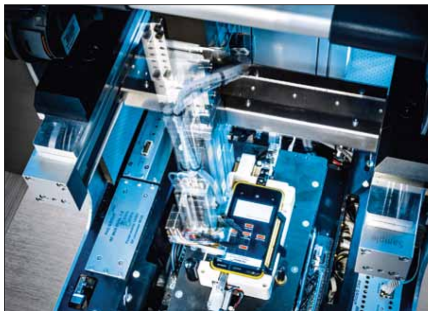
Slika 7. Natančno in hitro pozicioniranje v utesnjemem prostoru s ploskim dvorazsežnim H-portalom EXCM (foto: Festo AG &Co. KG).
