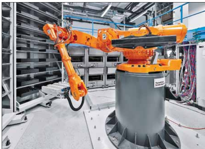
Slika 3. Postrojenje za popolnoma avtomatizirano formiranje baterij (foto: ZSW/Duckek).
