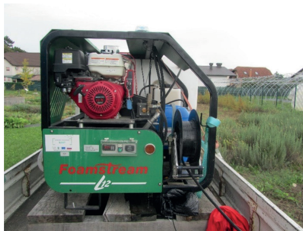
Z napravo Weedingtech ustvarimo vroči penasti tok Foamstream® (Foto: S. Žveplan)
