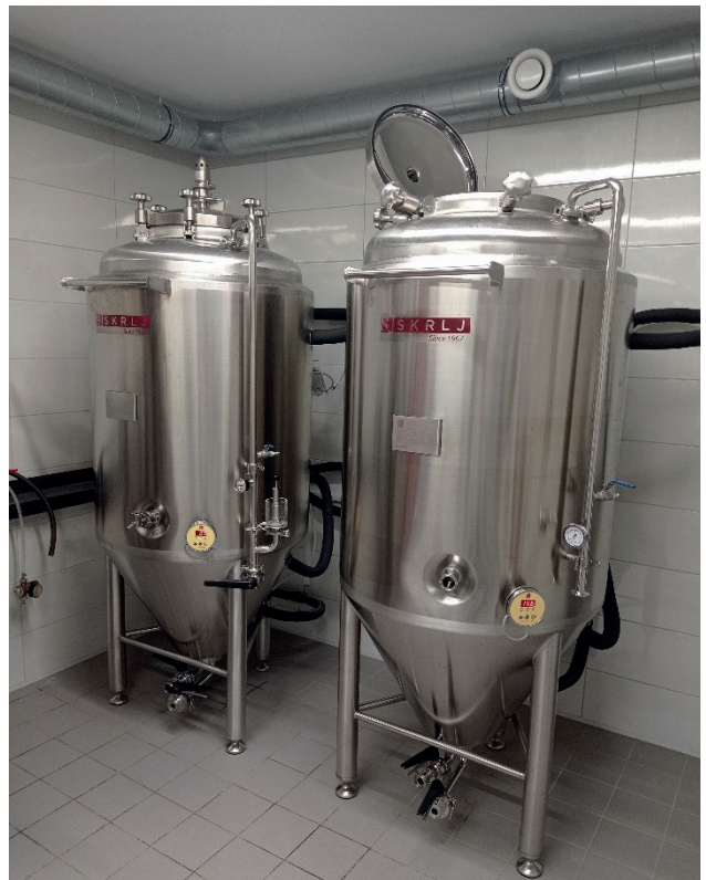
Vrelni-zorilni tanki kapacitete 500 litrov (Foto: J. Ozimek)
