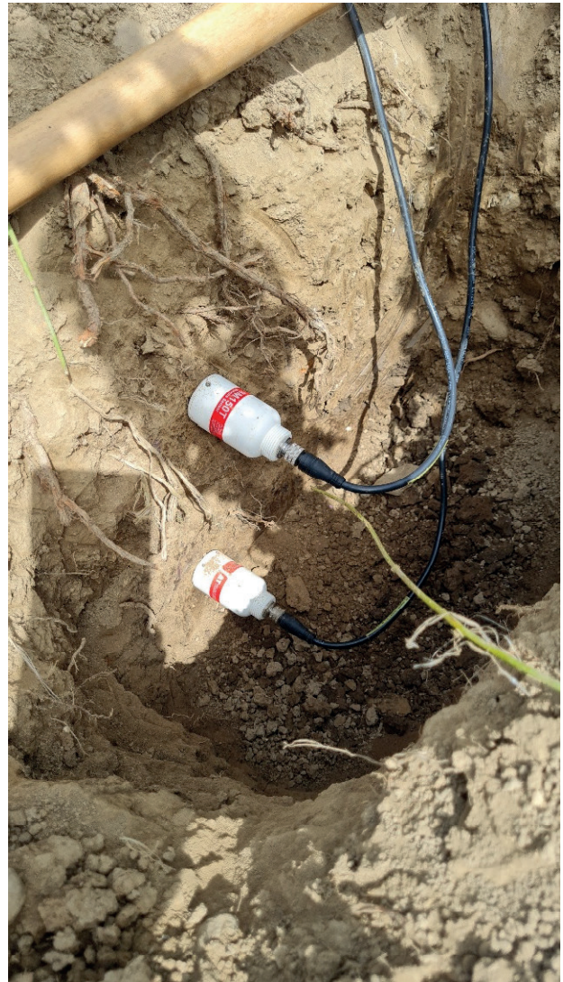
Sonde za merjenje vlažnosti tal, vstavljene v hmeljišču na globini 20 in 40 cm (Foto: B. Naglič)
