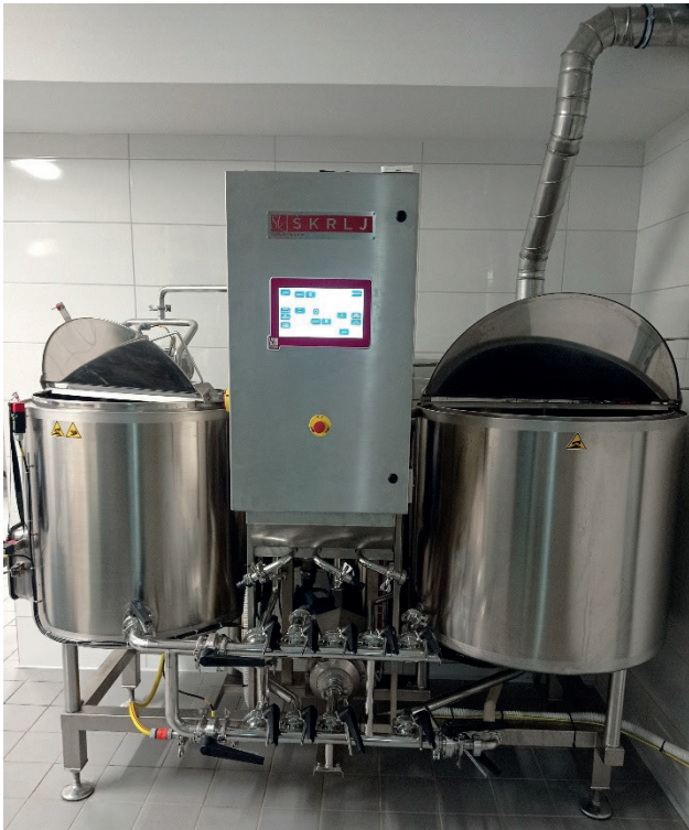
Sodobna varilnica kapacitete 250 litrov (Foto: J. Ozimek)
