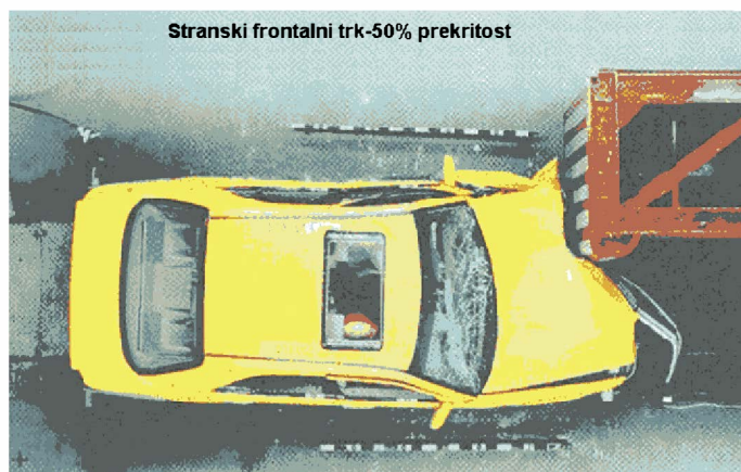
Slika 2: Test čelnega trčenja EURO NCAP pri hitrosti okoli 50 km/h
