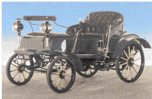
Slika 1: Oplov Patent Motorwagen System Lutzmann iz leta 1899: 3,5 PS , 20 km/h
