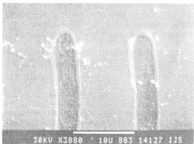
Slika 9. Zaključki črtic v rastru, posneti z elektronskim vrstičnim mikroskopom
