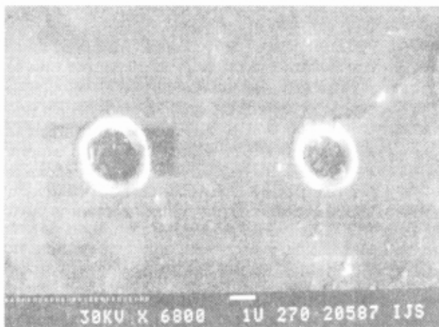
Slika 6. Najmanjše, še ponovljive okrogle luknjice v 100 nm debeli kromovi plasti
