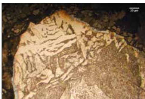
Slika 24. Metalografska analiza kovnega železa iz volka, pridobljenega pri taljenju 2017 v Železnikih. Leva slika nakazuje področje, kjer je prevladujoča feritna struktura s številnimi vključki žlindre. Desna slika nakazuje področja s prevladujočo perlitno strukturo, na meji z žlindro pa je prišlo do razogličenja in se nahaja ferit. Foto: Barbara Bertoncelej
