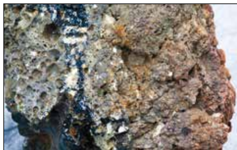
Slika 6. Presek ostanka stene peči s Štalce. Na levi strani fotografije so ostanki staljene stene notranje strani peči. Po preseku so opazni kamenčki kremenca, ki so jih lahko dodajali glini ali pa jih je glina vsebovala že sama.
