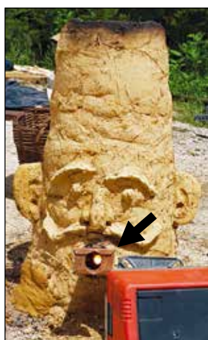
Slika 12. Nastavek z odprtino za opazovanje notranjosti peči.
