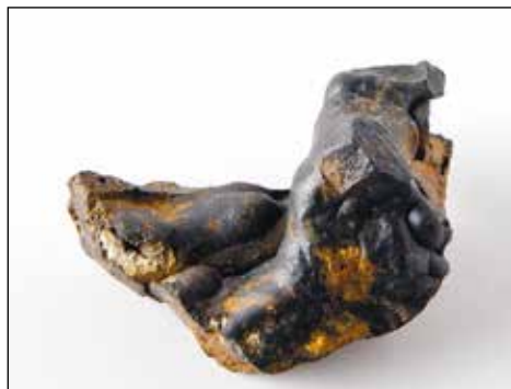
Slika 27. Ostanki tekoče žlindre s pobočja hriba Štalca.
