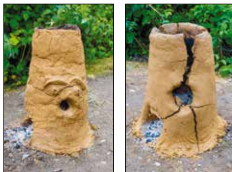
Slika 5. Armirana peč z dodatkom trave iz leta 2017 (levo) in ne-armirana peč iz leta 2017 (desno).
