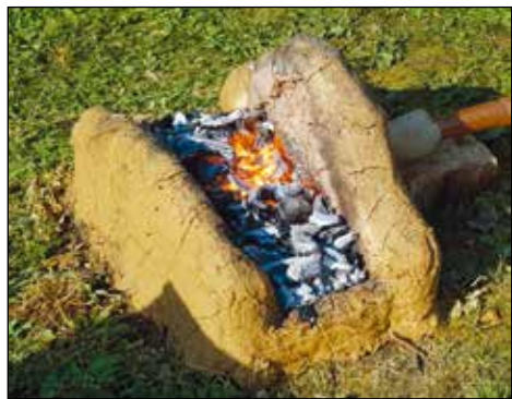
Slika 29. Talilno ognjišče med segrevanjem volka. Foto: Stane Zgaga
