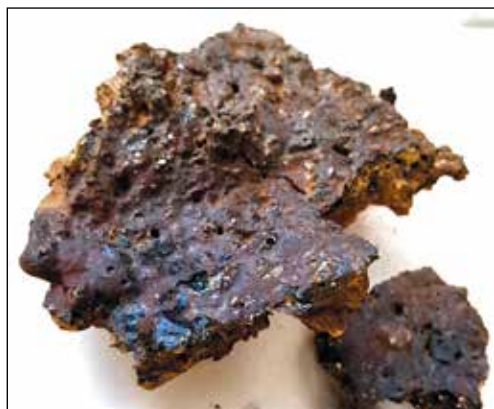
Slika 25. Ostanki staljene stene peči iz leta 2018.
