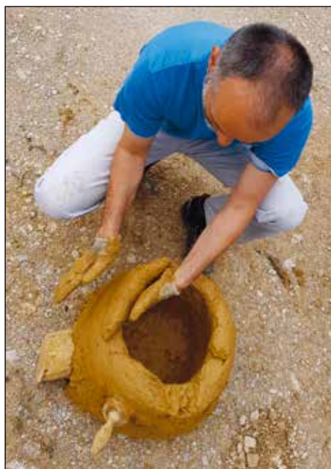
Slika 8. Bojan Rihtaršič pri izgradnji peči. Lesena čepa se po sušenju odstraniti, pri čemer spodnji služi za čiščenje peči in izpuščanje žlindre, v izpraznjen prostor zgornjega pa se vstavi šoba.
