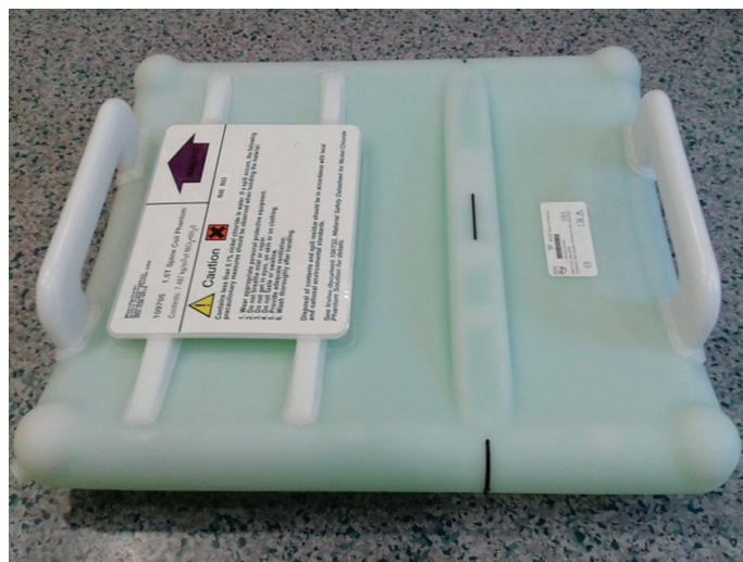
Slika 5: Fantom za izvajanje meritev RSŠ pri tuljavi za slikanje hrbtenice
