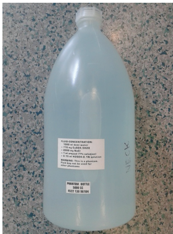
Slika 6: Fantom za izvajanje meritev RSŠ pri tuljavi za slikanje glave in vratu, in sicer za področje slikanja vratu
