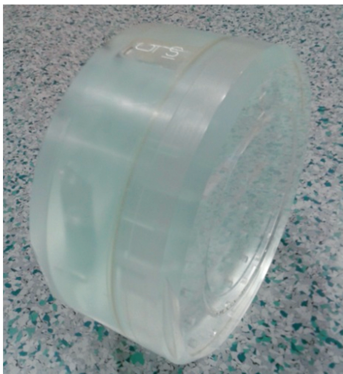
Slika 4: Fantom za izvajanje meritev avtomatskega preverjanja kakovosti in RSŠ pri tuljavi za slikanje glave ter tuljavi za slikanje glave in vratu in sicer za področje slikanja glave
