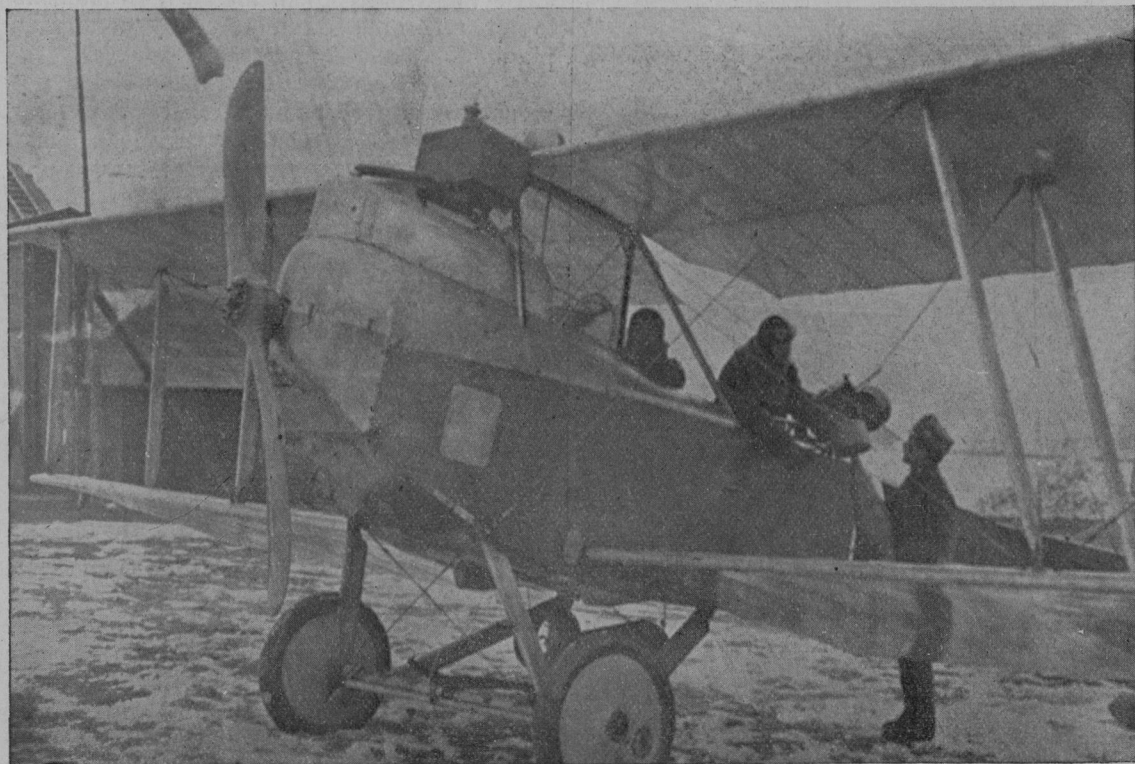
Slovo letalca pred vzletom. Pred njim sedi krmilar (pilot) pripravljen, da sproži motor. Letalo je dvokrovnik in se na sliki dobro vidi, da sta spodnje in zgornje krilo zvezani z drogovi.
