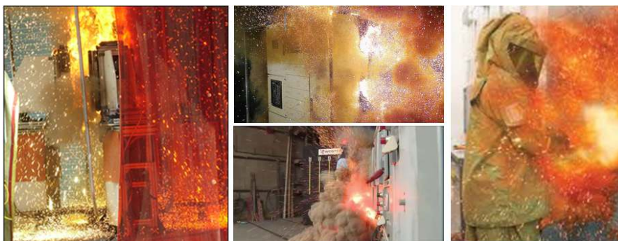
Slika 2: Električni oblok na električni omarici [3]
