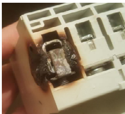
Sl. 7: Havarija na FID stikalu preko katerega se je napajala elektrarna.
