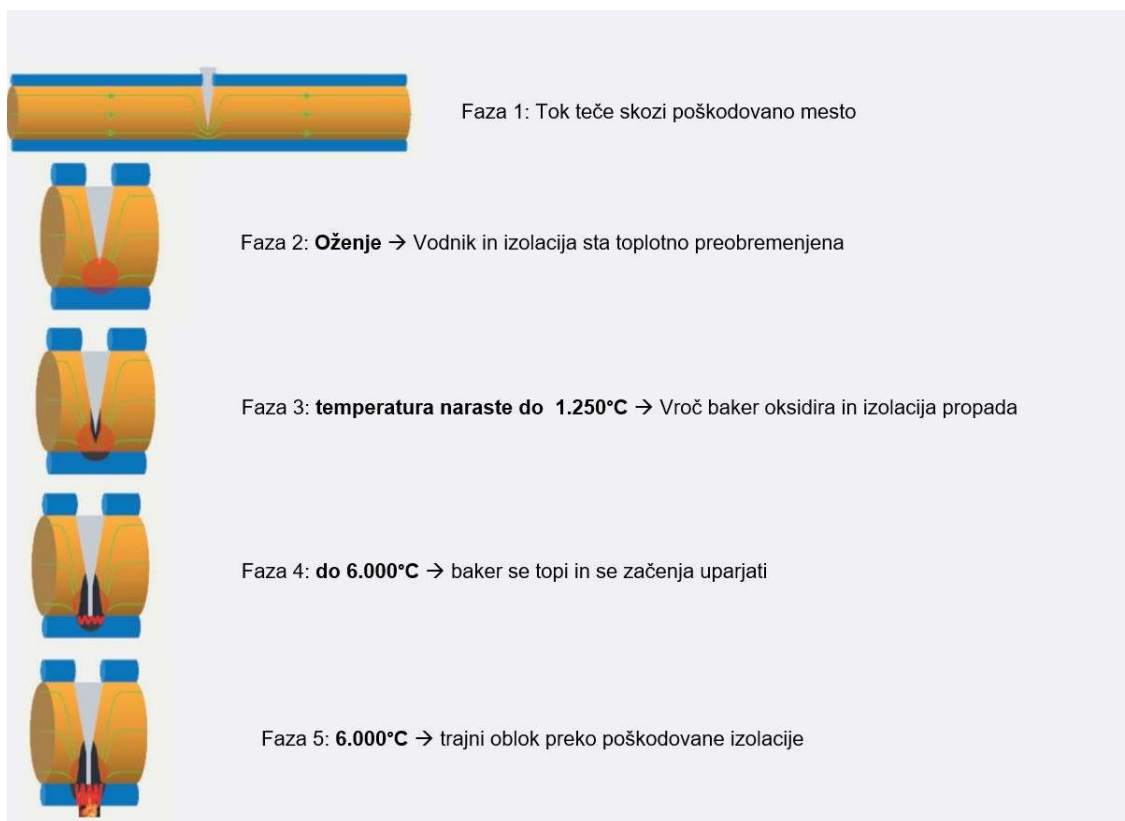
Slika 4: Faze razvoja škodljivega obloka
