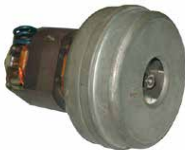
Sesalna enota 440.3.000 (Us 66 28 B 18) [5]. Te sesalne enote so dvostopenjske in imajo motor zaščiten s kovinsko cevjo, kar dodatno izboljša hlajenje.
