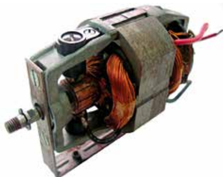
Univerzalni kolektorski motor za pogon ročnih sesalnikov 439.3.002 – DUA 120/12 [9]. Vir: arhiv Domela. Foto: Janez Rihtaršič
