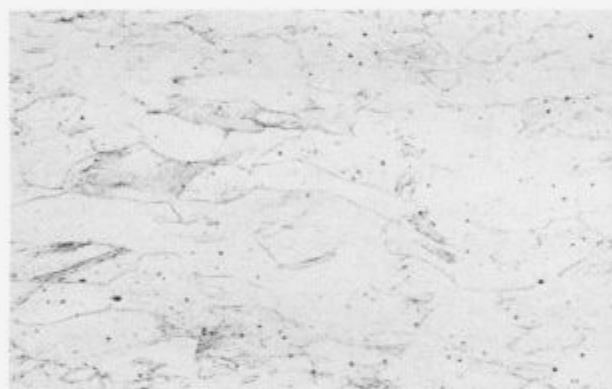
Slika 2: Mikrostruktura hladno valjanega jekla, legiranega z 0,052 % Sb (jedkano z nitalom, povečava 100×)
