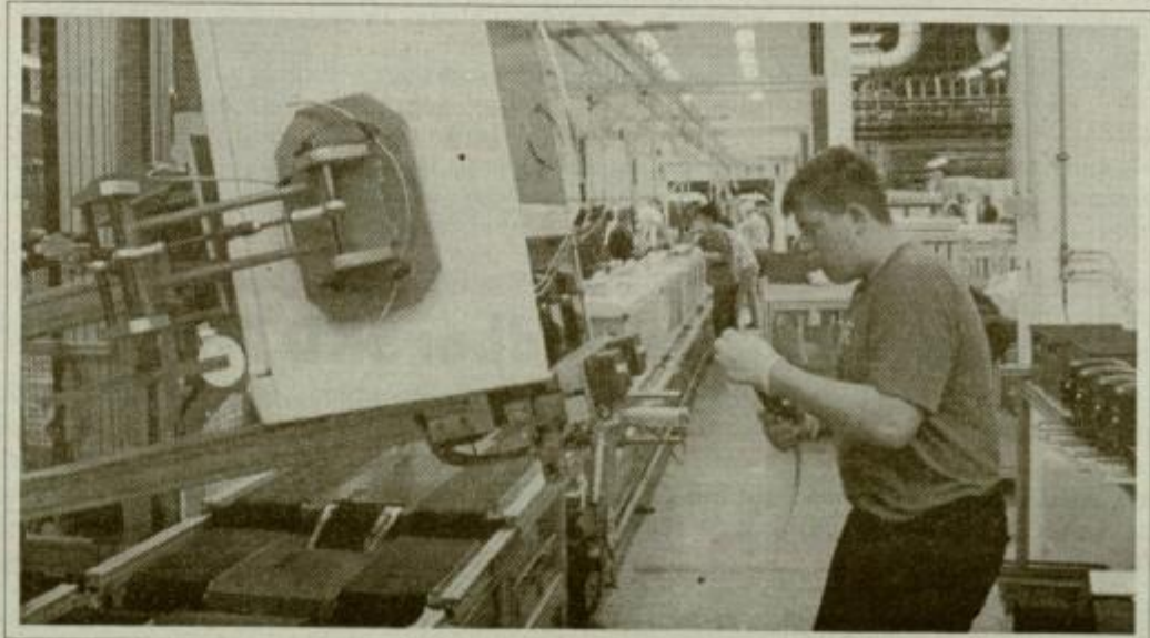
Montažne linije v novi tovarni hladilne tehnike so računalniško vodene, nadzor proizvodnje pa opravljajo tudi s pomočjo termovizijske kamere.
