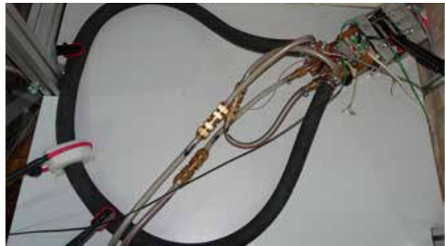
Slika 7 : Breme varilnega TR v obliki vodno hlajenega finožičnega vodnika
