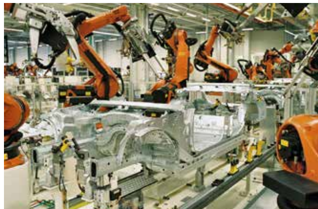
Slika 1: Uporovno točkovno varjenje karoserije avtomobila BMW serije 3 (Vir: wikipedia [2])
