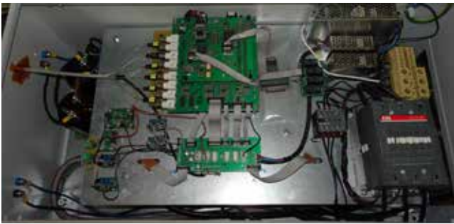
Slika 3 : Po meri izdelan laboratorijski frekvenčni pretvornik
