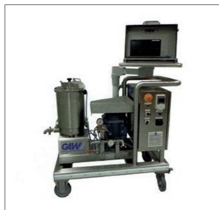
Slika 2. GAW laboratorijska dispergirna naprava Figure 2. GAW laboratory dispersing machine
