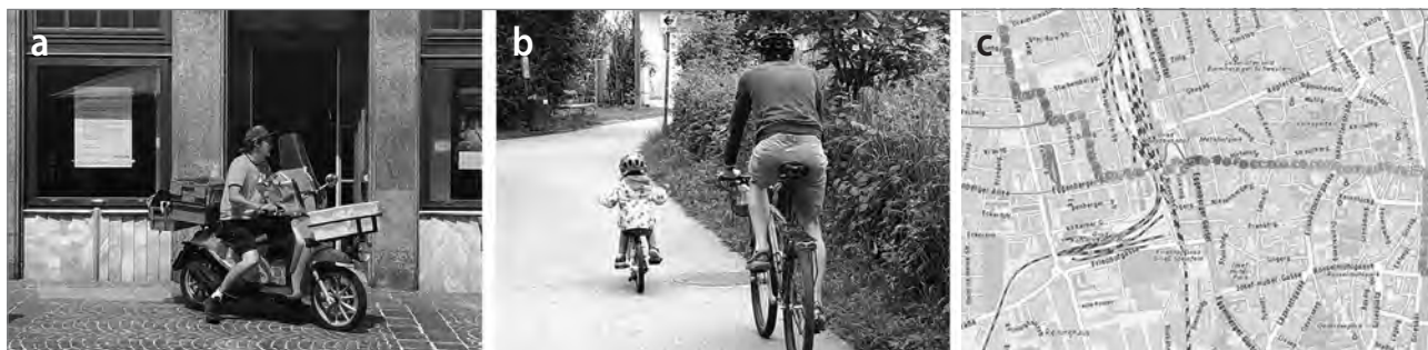
Slika 3: (a) Senzorji NB-IoT, nameščeni na motorna ali navadna kolesa, sestavljajo mobilno omrežje za neprekinjeno in poceni zbiranje podatkov o toplotnem udobju v javnem prostoru; (b) senzorji NB-IoT se lahko uporabljajo na katerem koli kolesu; (c) temperaturne razlike v razponu 2–3 °C, označene na cestnem zemljevidu v temno in svetlo sivih odtenkih (vir: avtorji)
