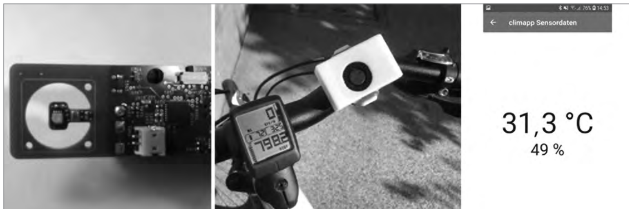
Slika 4: Prototip senzorja, ki omogoča mobilno zbiranje podatkov o lokalnem podnebnju (vir: avtorji)
