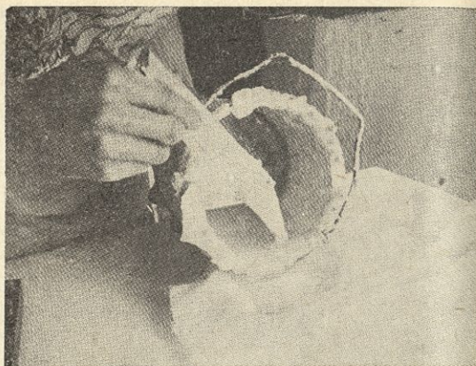
Slika 14. Zalivanje: V odprtino za kaseto za smernik vstavimo kos steklene volne in prelijemo s poliestrsko smolo (mešanico naredimo po »receptu« iz prejšnjega Tima).
