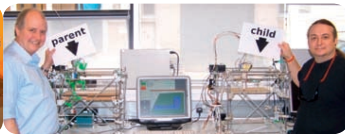
Tiskalnik RepRap, verzija 1.0 (Darwin). 3D-tiskalniku RepRap Darwin 1.0. je samo nekaj ur po izdelavi že uspelo izdelati svojega naslednika.
