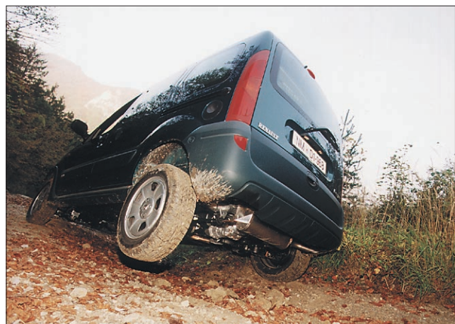
Prednji in zadnji odbijači iz prožnega materiala ter visoko nameščene luči izven območij najpogostejših udarcev zmanjšujejo poškodbe vozila in povečujejo njegovo varnost.
