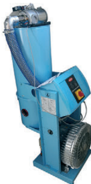
» Slika 2: Pametna trifazna črpalka zadošča za 2 do 6 polnilcev
