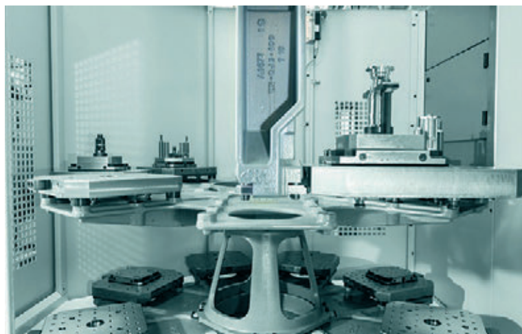
» Izmenjevalnik palet PW 150 nameščen na obdelovalnem centru C 22 UP s skupno 18 mesti za palete, ki so maksimalne velikosti 320 x 320 mm in teže od 2 do 150 kg.
