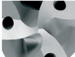
» Točkovni prečni rezalni rob novega trirezilnega svedra
