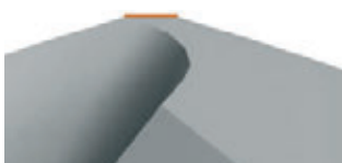
» Linijski prečni rezalni rob dvorezilnega svedra
