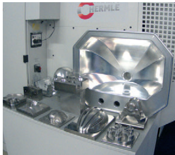
» Primeri pospešene obdelave: programski paket hyperMILL orodja EMUGE-FRANKEN in stroj Hermle C400 na delu
