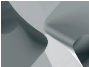
» Linijski prečni rezalni rob dvorezilnega svedra
