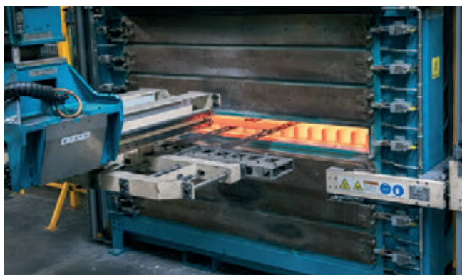
» Sistem z vgrajenimi senzorji zagotavlja popoln nadzor nad procesom ogrevanja in hlajenja.
