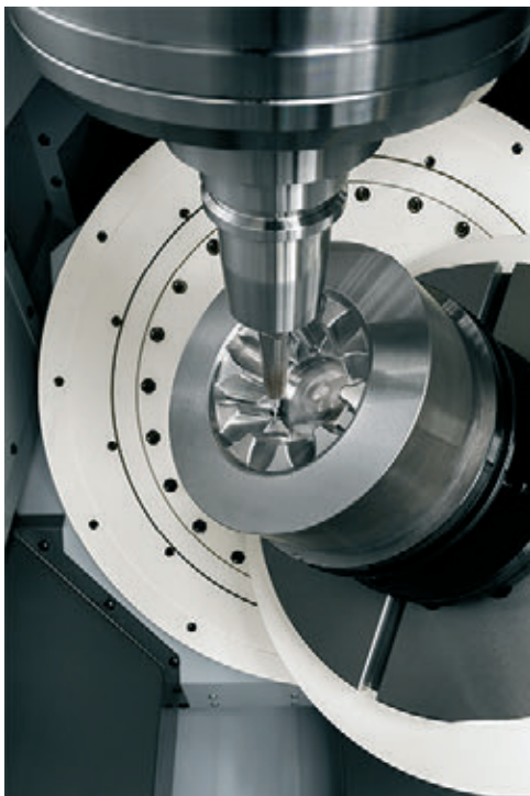
» Obdelava na 5-osnem vertikalnem obdelovalnem centru D200Z
