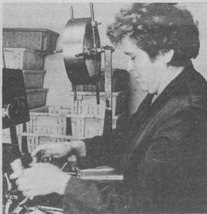
Zobne ščetke imajo različne oznake, ki so odvisne od števila luknjic, v katere mora stroj potisniti ščetine. Število luknjic določa tudi, koliko ščetk mora Zofija napraviti v osmih urah. Ta dan je Zofija Babnik delala ščetke številka 4. Če hoče doseči normo, jih mora v delovnem času narediti 1400. (Foto: DARJA JUVAN)
