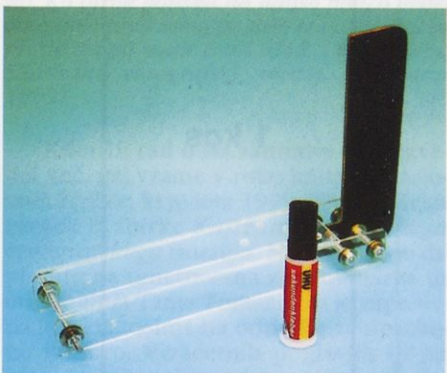
Enaka stranska dela in rep najprej pritrđimo z vijaki, nato prilepimo še zgornji del.
