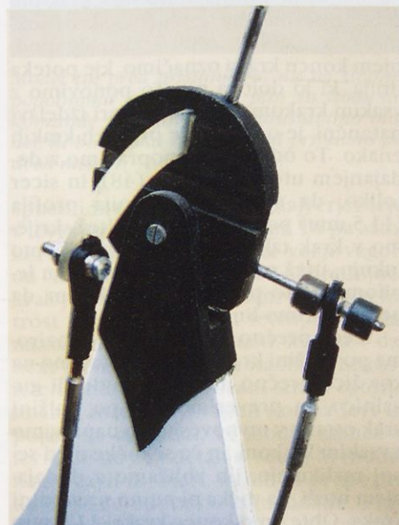
Vodilo glave rotorja, na katerem so dobro vidni krmilna vzvoda višine in smeri ter os rotorja
