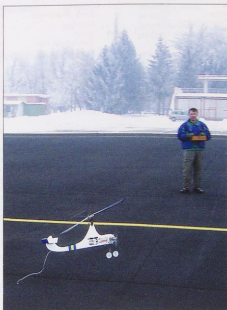
Model tik pred pristanekom: na tej stopnji popolnoma odzvamemo plin in dodamo komande za višino, tako zaustavimo model, ki bo pristal in se ustavil približno po dveh metrih.
