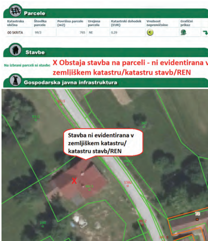
Slika 3: Aplikacija Javni vpogled v podatke o nepremičninah: zamisel o vključitvi opisa napak in neskladij v grafični in pisni del javnega vpogleda – primer stavbe, ki obstaja v naravi, a ni evidentirana v nobeni geodetski evidenci.
