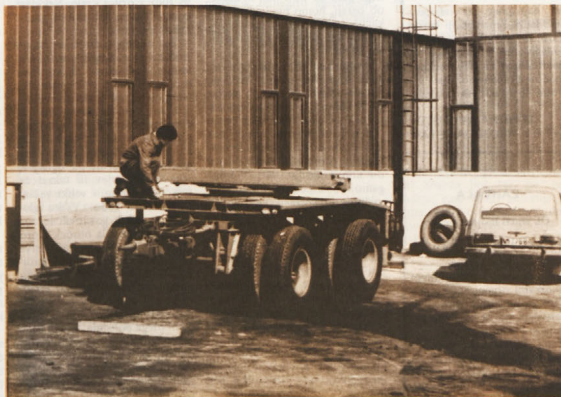
Na novo podvozje prikolice so v TOZD TES naredili ustrežajočo konstrukcijo za prevoz dolgih tovorov
