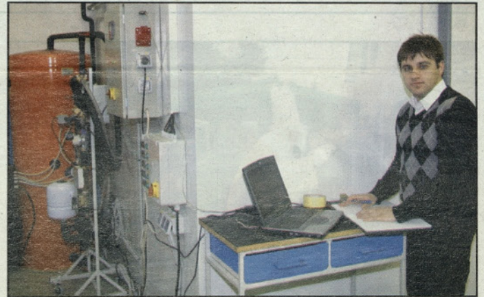
Računalniško voden laboratorij za testiranje toplotnih črpalk
