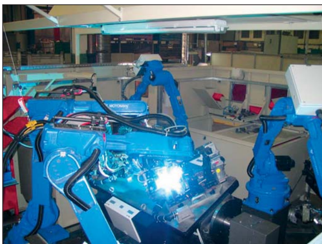
Slika 2. Robotsko varjenje, strega in optična kontrola zvarov
