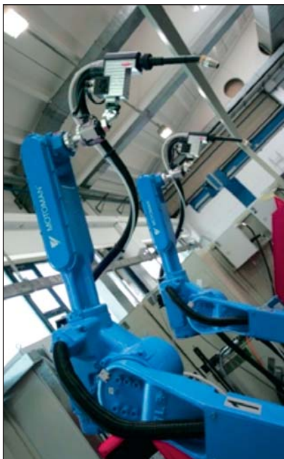
Slika 4. Robota z gorilniki za varjenje po postopku CMT
