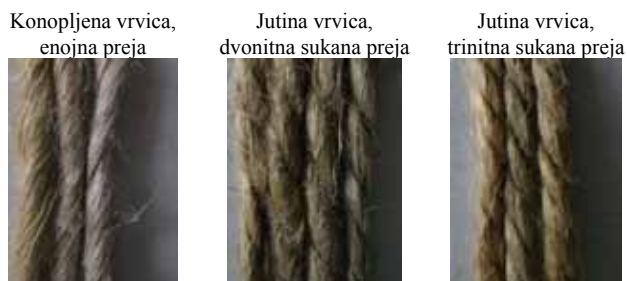
Slika 2: Vrvice iz konopljenih in jutinih vlaken so bile ob koncu rastne sezone hmelja v letu 2013 zaradi učinka sončne svetlobe (predvsem UV žarkov), rose, dežja in gnitja drugačne barve kot na začetku sezone; jutini vrvici sta spremenili barvo iz rdečkaste v sivkasto, konopljena pa iz rjavkaste v sivkasto.
