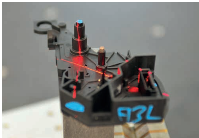
» Cross Scanner med digitalizacijo zahtevnega dela vratnega zapirala
