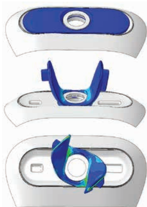
» Slika 4: MKE-simulacija prve konceptne rešitve odpiranja in vrtenja pokaže zatikanje pokrovčka.
