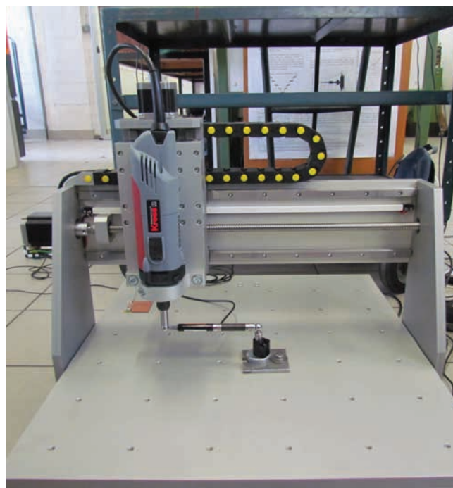
» Slika 9: Postavitev senzorja LVDT za izvedbo preskusa z ballbarjem
