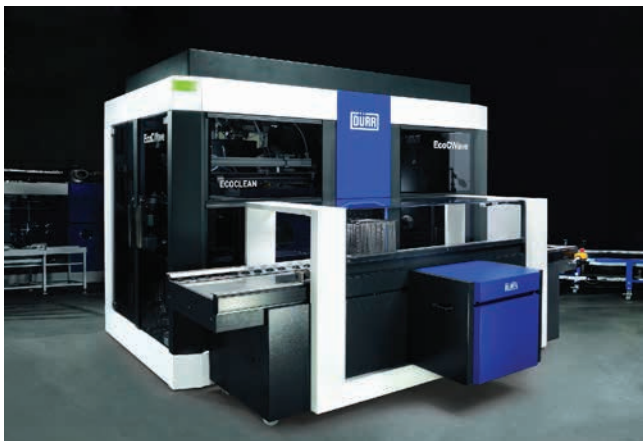
» Odvisno od opreme je mogoče vodne enoprekatne čistilne sisteme uporabljati tako za grobo kot tudi fino čiščenje. | Foto: Dürr Ecoclean GmbH
