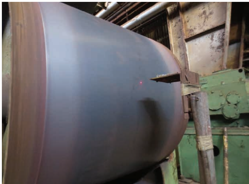
» Slika 1: Jekleni trak pred vstopom v stroj za peskanje. Rdeča svetloba pomaga prilagoditi postopek na različne materiale.
