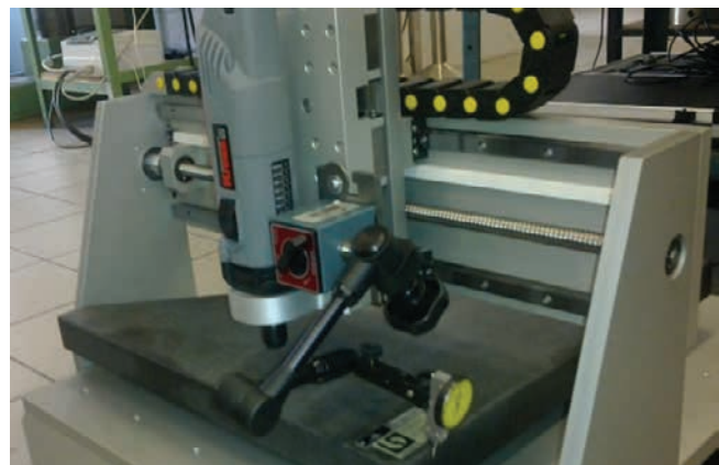
» Slika 11: Merjenje pravokotnosti osi x in y s tisočinsko merilno urico
