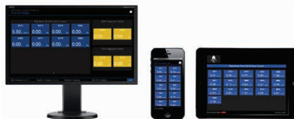
» Slika 3. Podatki iz tirnih tokokrogov proge na zaslonu na dotik v prostoru z opremo, na pametnem telefonu in na tabličnem računalniku (od leve proti desni)
