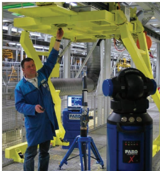
» Track ScanArm je še posebno zanimiv zaradi svoje mobilnosti med merjenjem montažnih priprav.
