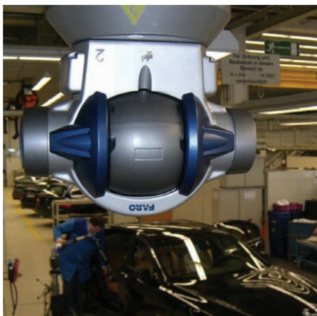
» Laser Tracker je obešen na strop v Dingolfingu, zato je izključen kateri koli zunanji kontakt.
