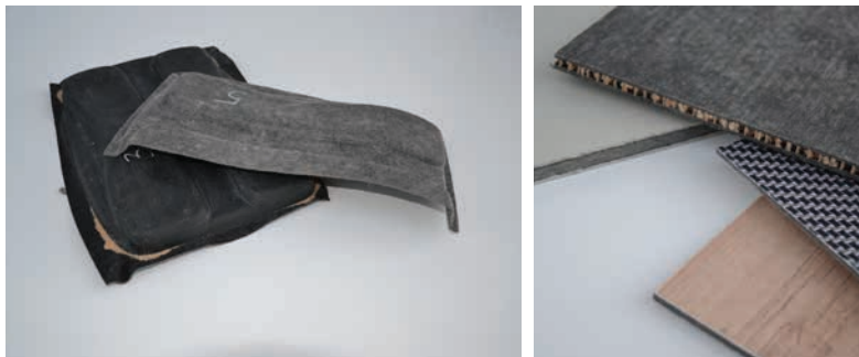
» Sliki 3 in 4: Tehnologije vročega stiskanja termoplastičnega stiskanja termoplasta, ojačenega z vlakni – ojačitve sami kontroliramo lokalno med postopkom.
