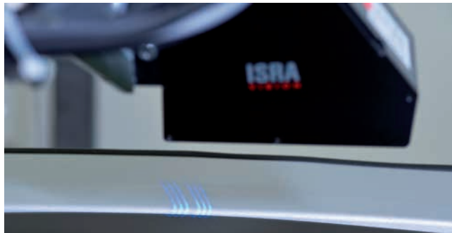
» Slika 2: Največja natančnost za največjo zanesljivost procesov: prilagodljiva in natančna tehnologija merjenja za avtomatizirano vstavljanje vetrobranskih stekel
