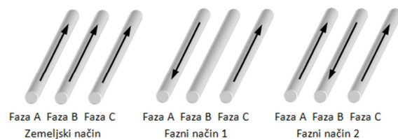
Slika 1: Trije načini priključitve sistemov PLC na VN vod s tremi faznimi vodniki v horizontalni razporeditvi
