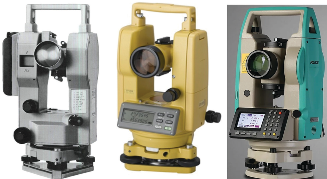
Slika 5: Enostavni elektronski teodoliti: Zeiss ETH-4 (Opton, 1986), Topcon DT-200 (objavljeno z dovoljenjem GeoWild Sarajevo) in Ruide Disteo 23 (Ruide, n. d.).
