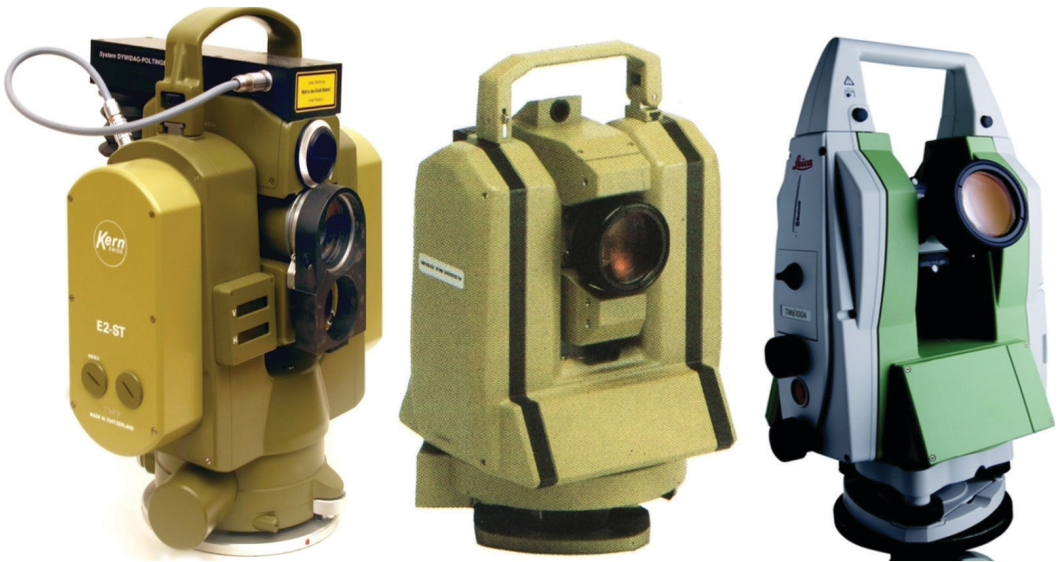
Slika 6: Servoteodolit Kern E2-ST (objavljeno z dovoljenjem Stadtmuseum Aarau, Sammlung Kern. Foto: Aldo Lardelli), video-teodolit Wild TM3000V (Wild Leitz, 1989) in industrijski teodolit Leica Geosystems TM6100A (objavljeno z dovoljenjem Geokom Sarajevo).
