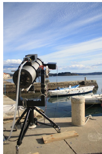
Slika 2 – Mobilni lidarski sistem Centra za raziskave atmosfere Univerze v Novi Gorici.
