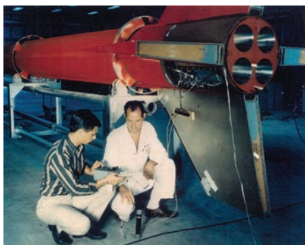
Zgornjo stopnjo aerobee so poganjali štiri v snop vezani motorji na tekoče gorivo, povzeti iz rakete aerobee 150A. (Foto: NASA)
