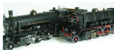
Vsi detajli na modelu SŽ 03-002 so izdelani zelo filigransko. Poznavalec pa bo tudi tu opazil, da se posamezni deli, kot so dinamo, kompresor, tlačne posode itd., tako po obliki kot legi razlikujejo od tistih pri SB 109.13.
