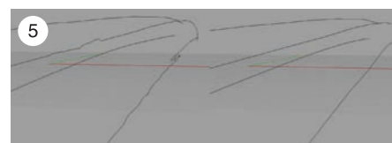
Popravilo gladkosti vodilnih krivulj. Na levi je stanje pred in desno po popravilu [1].
