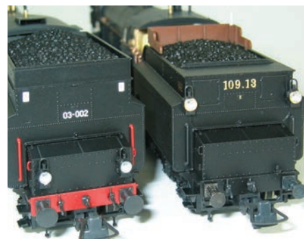
Na zadnji strani kovinskega zalogovnika sta vgrajena dva žarometi, ki se napajata prek svetlobnega kanala. Modela lokomotiv SŽ 03-002 in SB 109.13 imata zadnje žaromete na zalogovniku na različnih mestih.
