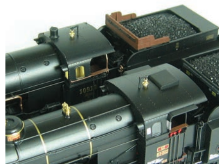
SŽ 03-002 in SB 109.13 se med seboj razlikujeta tudi po obliki in velikosti kabine.
