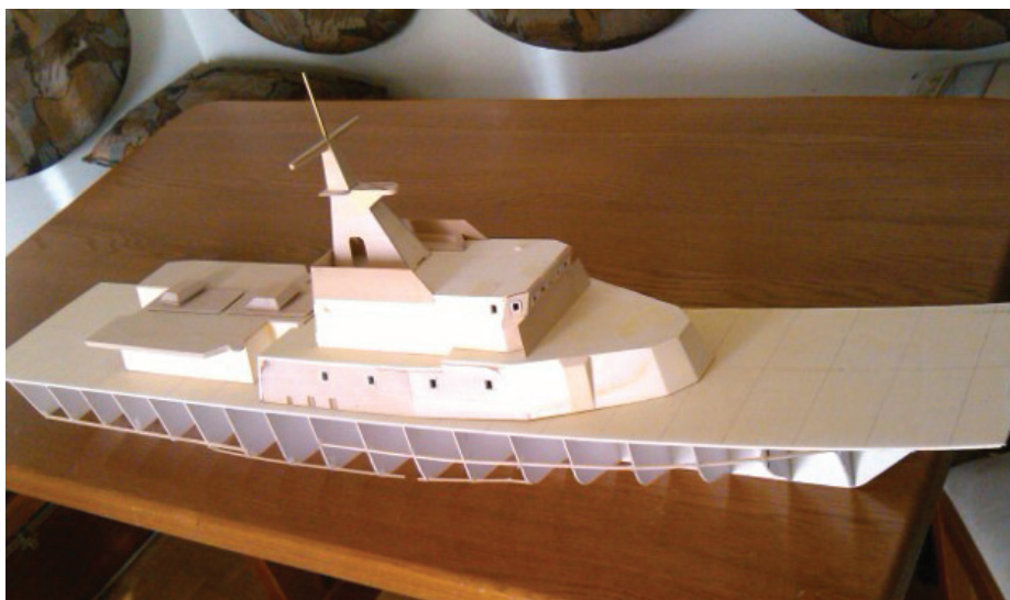
Nadgradnja makete je izdelana iz 3 mm debele topolove vezane plošče in 0,8-mm letalske vezane plošče.
