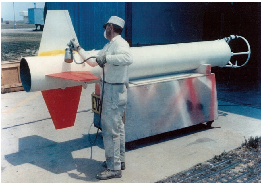
Barvanje stabilizatorjev pogonske stopnje nike v značilno fluorescentno rdeče-rumeno barvno shemo (Foto: NASA)
