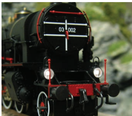
Dva velika žarometi na sprednji strani lokomotive delujeta zelo prepričljivo. Svetloba v oba prihaja po svetlobnem kanalu od svetleče diode. Če ima model vgrajen dekodirnik, lahko žaromete vklaplamo in izklaplamo na digitalni centrali.
