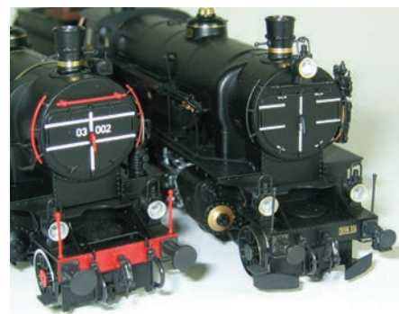
Model lokomotive SŽ 03-002 se na sprednji strani poleg barvanja od modela lokomotive SB 109.13 razlikuje tudi po številu žarometov.
