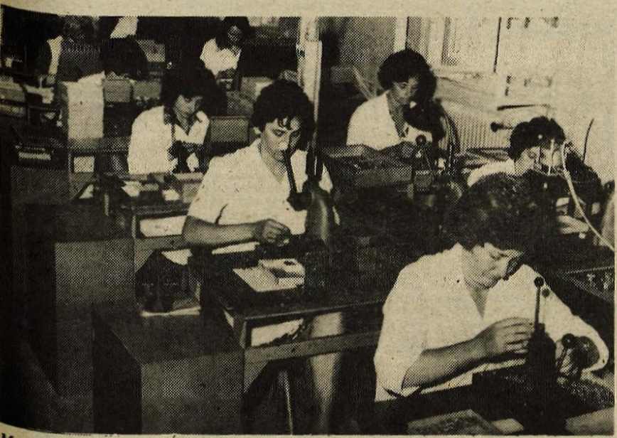
Montaža dvotarifnega številčnika
