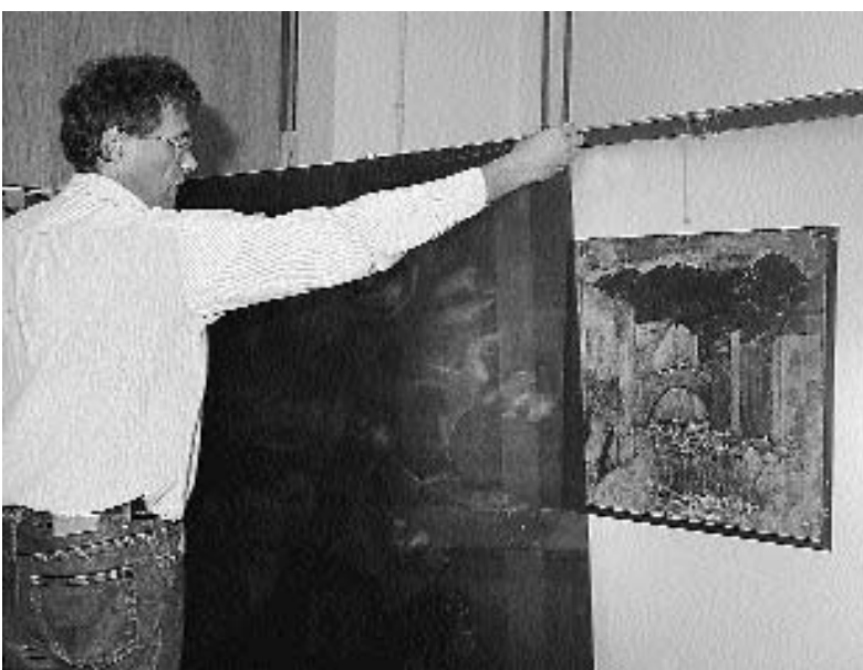
4. RC RS, laboratorij nedestruktivnih preiskav, osvetljena plošča za pregled radiografov večjih formatov
