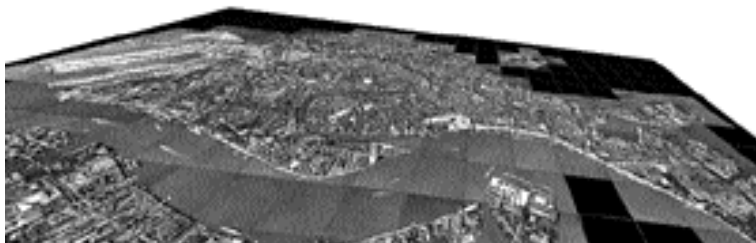
Slika 3: Perspektivni pogled fotokarte Benetk, pridobljen z uporabo projektivne transformacije
