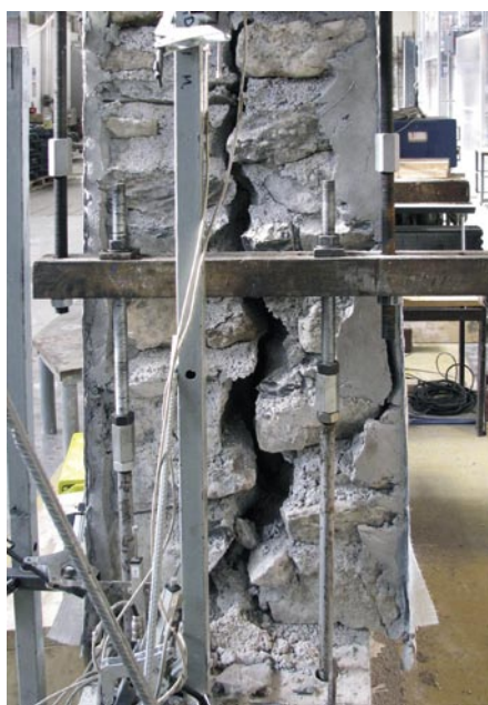
Slika 11 • Utrditve tipa 4. a) Razpoke v zidu pri končnem mejnem stanju; b) razslojitev zidu
