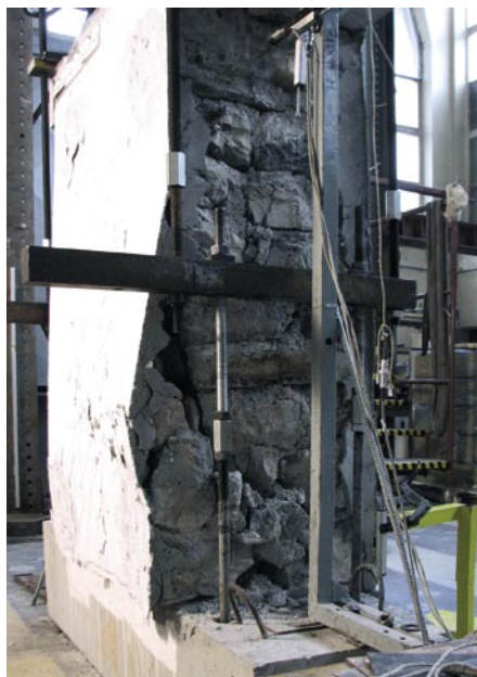
Slika 10 • Utrditve tipa 3. a) Razpoke v oblogi pri končnem mejnem stanju; b) izbočenje obloge in razslojitev zidu
