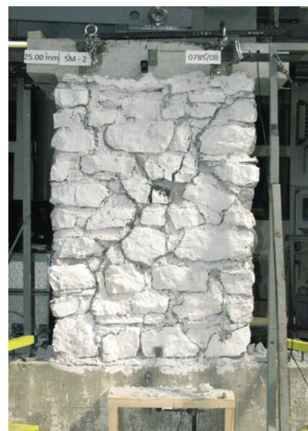
Slika 7 • Poškodbe referenčnega neutrenega zidu pri končnem mejnem stanju
