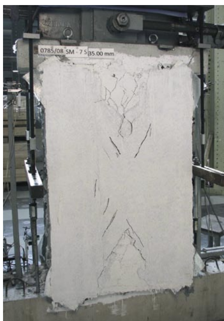
Slika 11 • Utrditve tipa 4. a) Razpoke v zidu pri končnem mejnem stanju; b) razslojitev zidu
