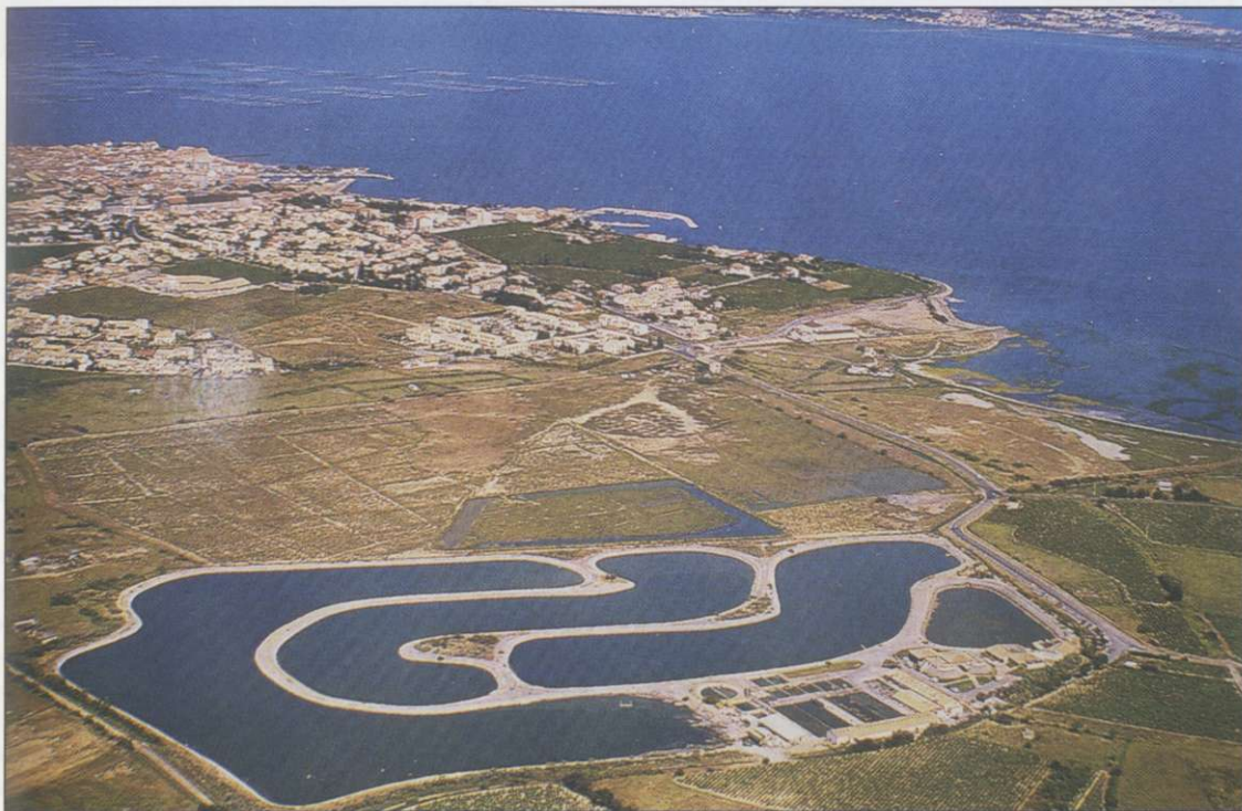
Slika 2: Čistilna naprava pri kraju Meze ob severni obali Bassin de Thau. Služi prečiščevanju komunalnih odpadkov mesta, hkrati pa proizvaja tudi plankton, s katerim gojijo ribe. Ob njej je nastal raziskovalni center za ekološke študije, ki se ukvarja s prosvetljevanjem učencev in odraslih. (Foto: J. Cigler.)
