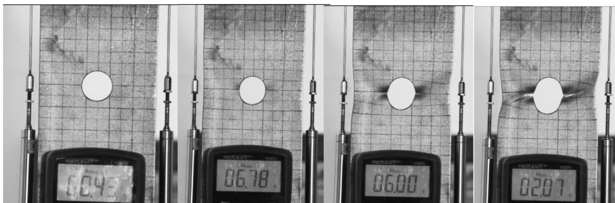
Slika 11: Preizkušane H10 med testom (elastično območje 4,3 kN, največja odpornost 678 kN, trenutek pred prvo razpoko 600 kN, prelom 207 kN)
