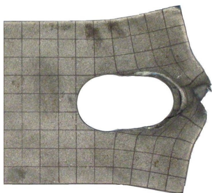
Slika 27: porušitev z razkolom preizkušanca B111
