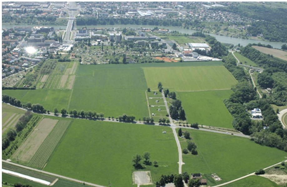
Slika 3 • Pogled na črpališče mariborskega vodovoda na Vrbanškem platoju z druge stani pokaže na bližino mesta. Zaradi debele krovne plasti je tudi na ožjem zaščitnem pasu črpališča mogoča kmetijska proizvodnja brez pesticidov ob odmerjeni uporabi umetnih gnojil. Zaradi bližine mesta pa bi bilo mogoče po vzoru črpališča Hadrholf v Zürichu te površine uporabiti tudi za rekreacijske in parkovne površine
