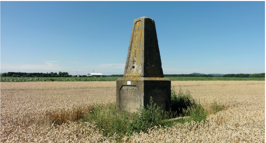
Slika 3: Nadzemna stabilizacija točke 218 SBT (vir: GI, foto: N. Fabiani).
