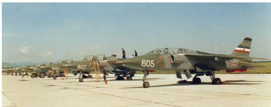
Dvosedi orli iz sestava 82. AB/351. IAE, nameščene na letališču Cerklje ob Krki. Letali s serijskima številka 25602 in 25605 sta iz predserije petih letal, 25607 pa je INJ-22 prve serije, v kateri je bilo izdelanih pet letal. (Vir: zbirka avtorja)
