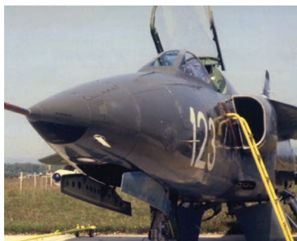
Enosedi jurišnik J-22 orel 2, ki je že imel motorja z dodatnim zgorevanjem. Pod desnim krilom je TV-vodena raketa zrak-zemlja AGM-65 maverick. (Vir: zbirka avtorja)
