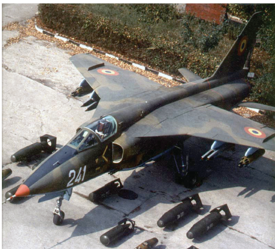
IAR-93B je bila končna romunska različica. Letalo na sliki je bilo eno zadnjih, narejenih v Romuniji. Prikazano je z vrstami orožja, s katerim je bilo lahko oboroženo. (Vir: Vlad Danuț)
