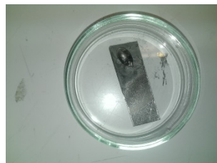
Testiranje Galinstana na reagiranje z nekaterimi materiali
